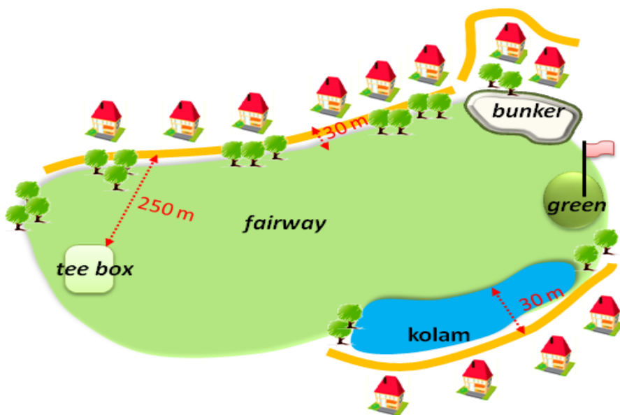
Rajah 4: Ilustrasi zon penamparan dalam bentuk jalan raya, pokok, kolam dan bunker sekiranya kediaman dibangunkan berselari dengan fairway
